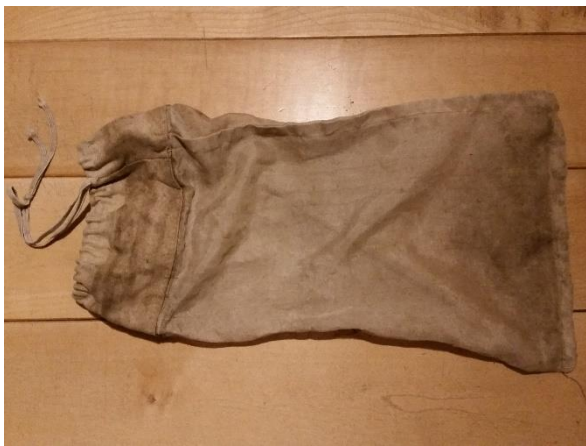
Abb. 6: In das Rohr des Motorsaugers wird ein Gazebeutel mit einer Maschenweite von 200 \mu\text{m} eingehängt, der die Fauna abfängt.
